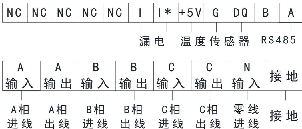
ASCP320 限流式保护器接线端子图
