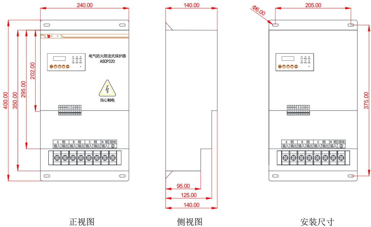
ASCP320-160B、ASCP320-200B、ASCP320-250B 限流式保护器的外形与安装尺寸如下图所示（单位 mm）：
