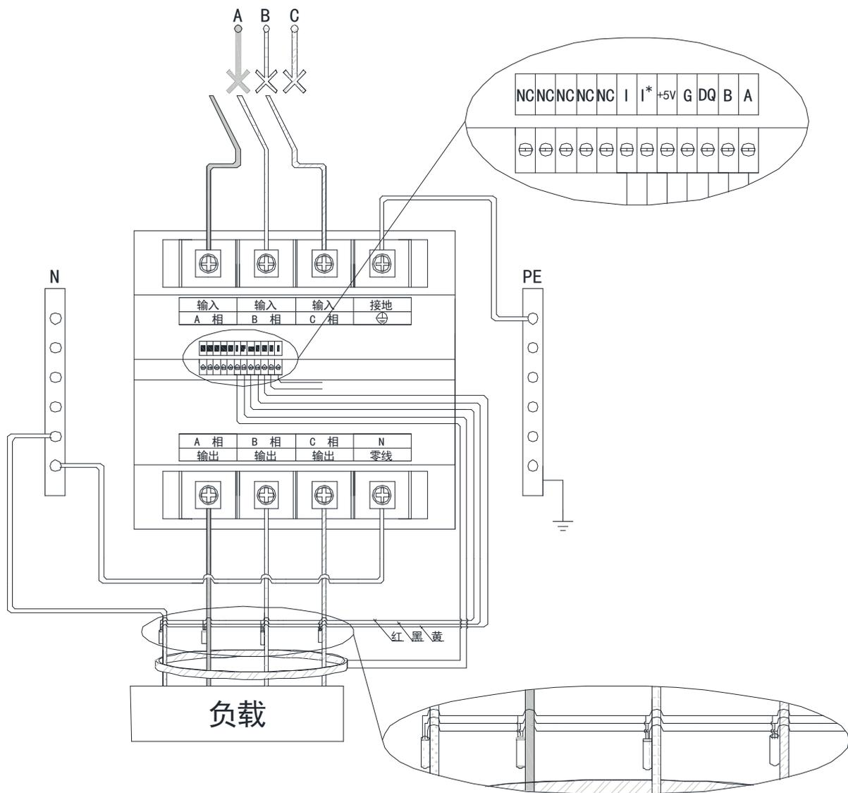
ASCP320-160B/200B/250B 限流式保护器的应用接线图
