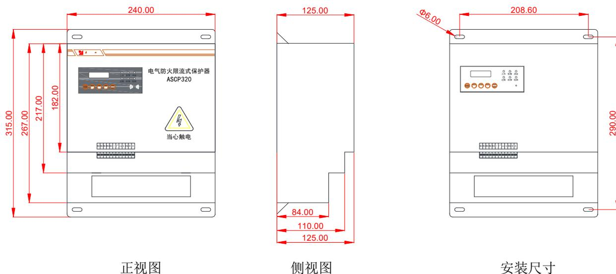
ASCP320-80B、ASCP320-100B、ASCP320-125B 限流式保护器的外形与安装尺寸如下图所示（单位 mm）：
