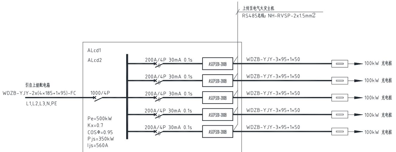
注意：电气防火限流式保护器应接在断路器后方，如果采用 3P 断路器则零线另外接入。
