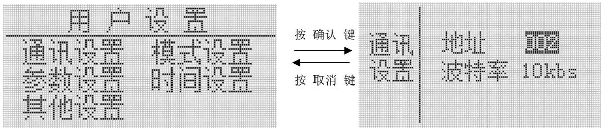
2) 选择“模式设置”，可更改照明检测：关闭/打开；故障应急：启用/关闭；DI联动：启动/关闭。
