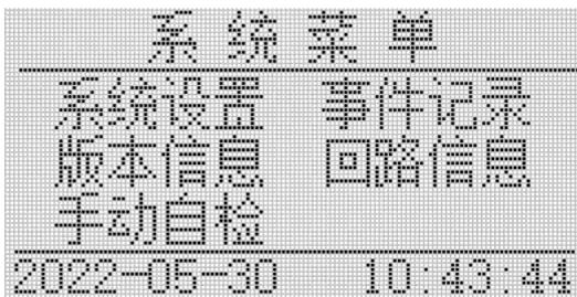
1) 选择“系统设置”，输入密码 0001，按“确认”键，进入“用户设置”界面，选择“通讯设置”，可更改配电箱的地址。
