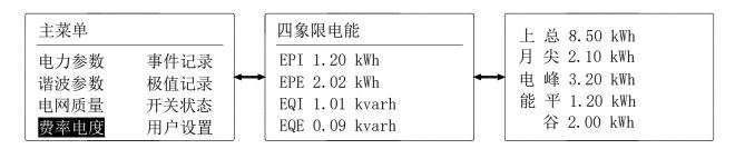
注:该系列仪表电能显示二次侧电能、一次侧电能可选,四象限电能分别指吸收有功电能、释放有功电能、感性无功电能、容性无功电能。仪表在选中费率电度后按回车键显示四象限电能,此时按左键或右键切换显示上月、上上月、总的复费率电能。
