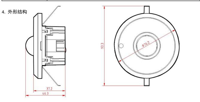
安装提示:本产品便于安装,采用嵌入式安装方式,通过使用产品左右两侧的弹簧片进行固定。该传感器安装孔2寸大小 $\phi$ 58mm $\pm$ 3mm,安装过程中必须保证产品的操作、安装、测试以及维修正确。
