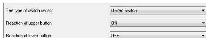
每联开关对应两个按键，每个按键的具体操作通过 Reaction of upper button 和 Reaction of lower button 可以设置上下键分别对应的功能是开灯或是关灯。智能面板通信对象和其他驱动模块的通信对象绑定后，面板发送开关报文，驱动模块就执行相应的工作（如：灯的亮灭等）。
