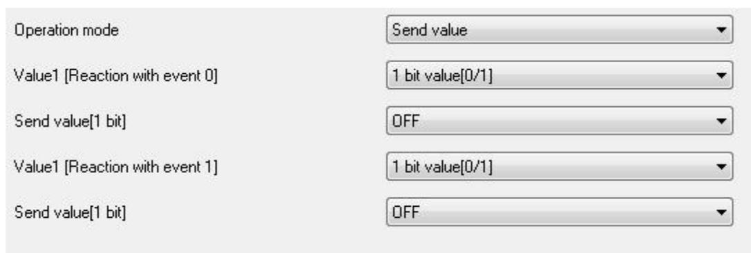
数值发送功能是通过参数设置预定数值，触发发送条件后对应的数值就发送到总线上。干接点模块的触发方式有两种：**event 0** 是在按下按键或外接端子导通时产生一个下降沿；**event 1** 则是在按键松开或外接端子断开时产生一个上升沿。具体参数设置如下：
