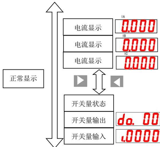
注：单相电压表与 AI 菜单结构类似，只有一处不同：电压、频率替代电流；
