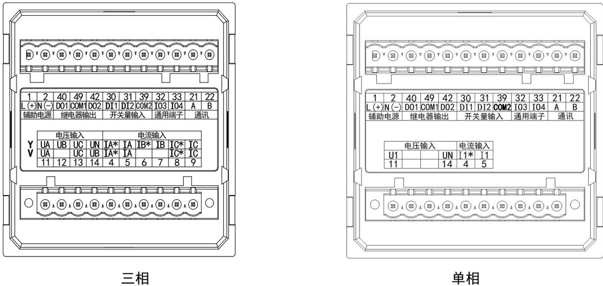
图 7 AMC72 系列接线端子图
