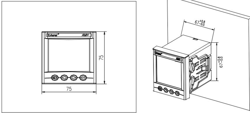
图 3 AMC72 安装尺寸
