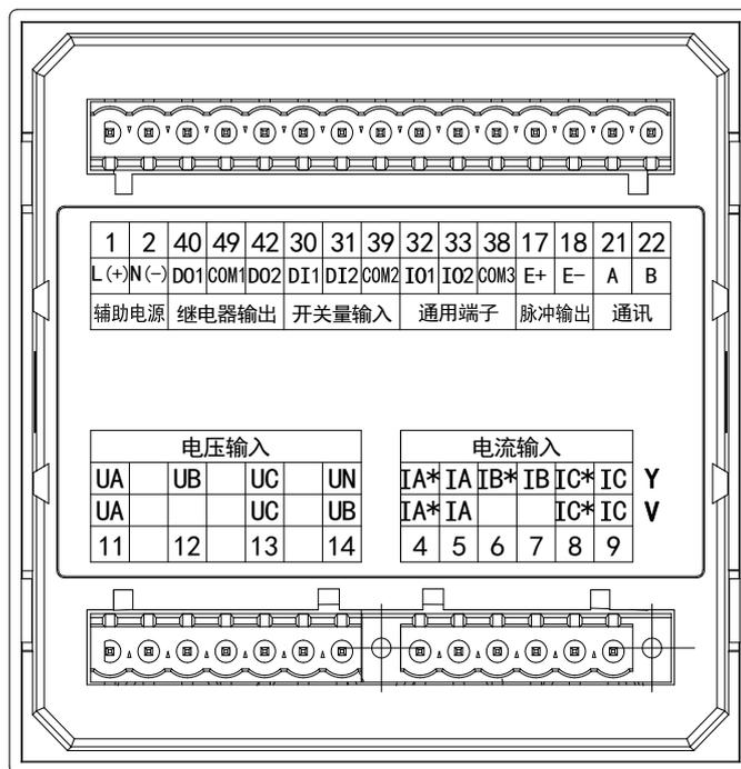
图 8 AMC96 系列接线端子图
